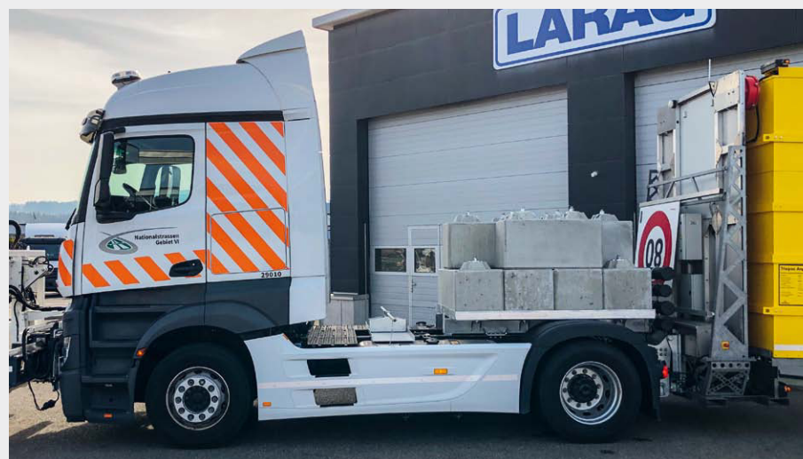
SwissBlock®-TEC kraftschlüssig mit Fahrgestell verschraubt.
